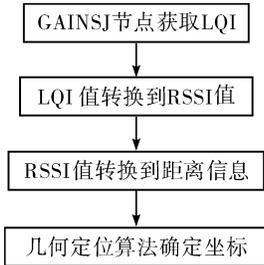
图 2 定位算法基本流程图
