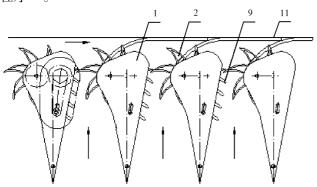
图 2 双重拨草机构简图 1—分草板;2—拨草星轮;9—橡胶拨草外轮;11—输送 平面
