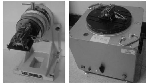
(a) 分度头测量倾角 (b) 水平转台测量方位角
