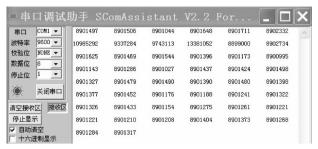
图 5 连续施加 4 次压力时无滤波算法的读数
