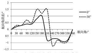
图 9 有干扰源校准后电子罗盘误差曲线
