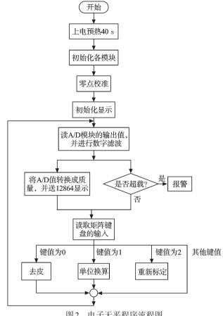
图2 电子天平程序流程图
