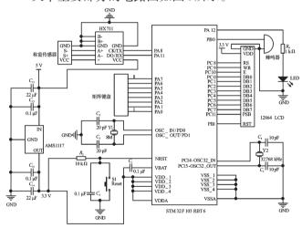
图1 电子天平主要部分电路图
