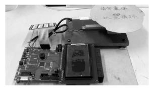
图7 电子天平实物图
