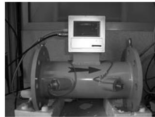
图2 超声波流量计样机
