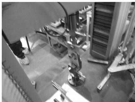
图7 实验装置及锁块核心系统的夹持装置
