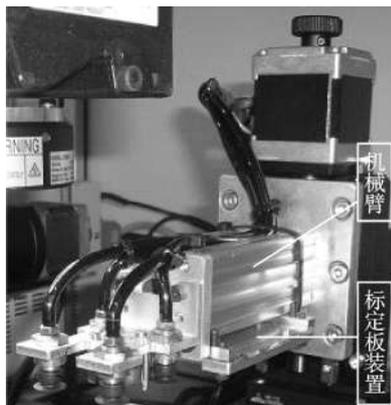
图7 标定板安装示意图
