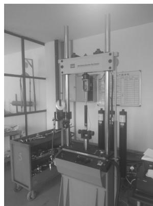
图2 台架上弹性夹持测试
