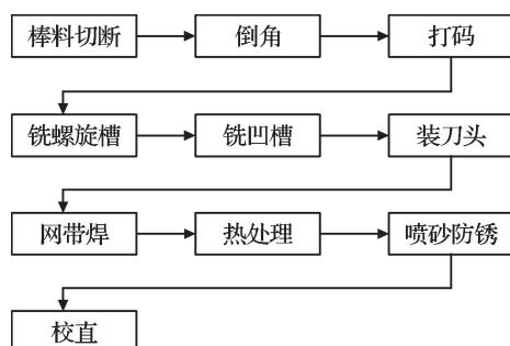
图3 钻头生产流程图
