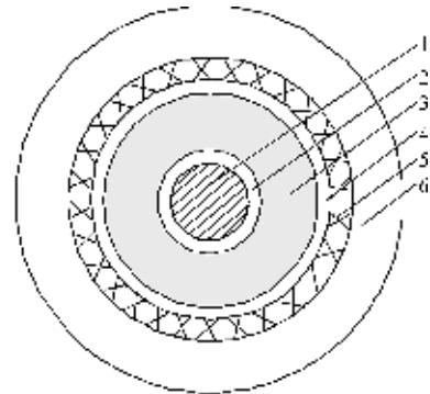
图 3 柔性电缆结构示意图
