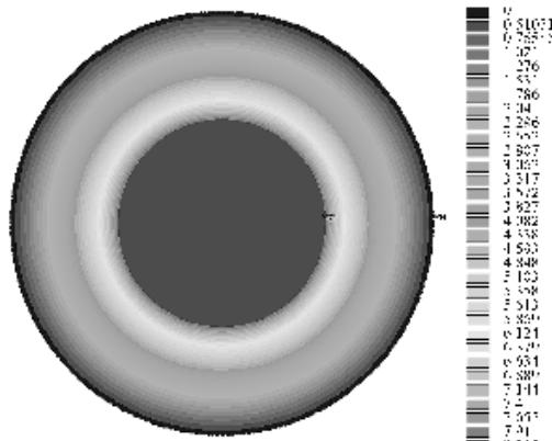
图 4 电缆电位分布云图
