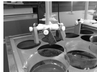
图 3 旋转挂片试验装置
