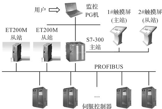
图6 控制系统总体方案示意图
