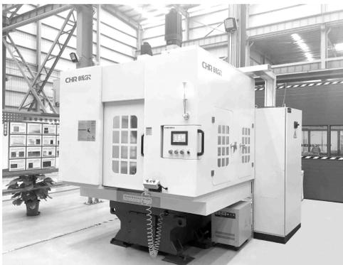
图 7 拉床整机图
