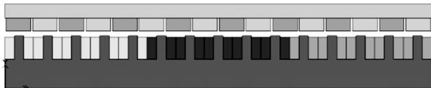
图 7 等永磁体用量条件下的 S-PMLSM 单元电机模型
