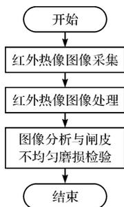
图 1 电梯闸皮不均匀磨损的检验流程
