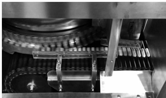
图5 原双层结构的传统传动链条实物
