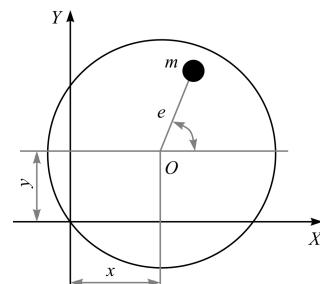
图 1 转子涡动示意图
