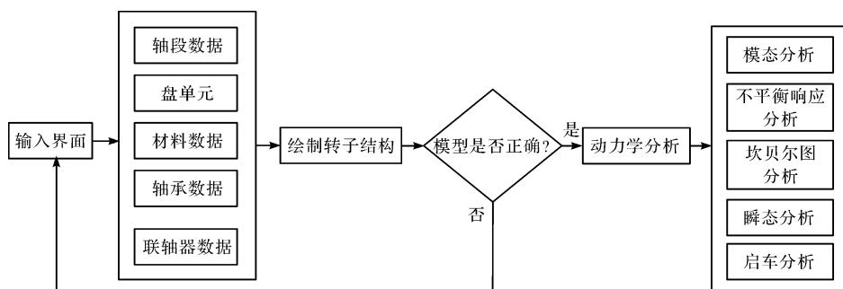
图2 软件计算流程图
