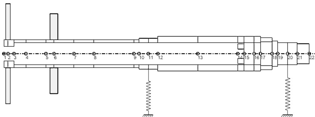
图6 转子有限元模型
