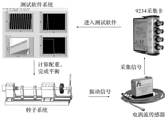
图 8 测试系统流程图
