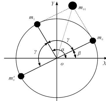
图 3 平衡过程中加重示意图
