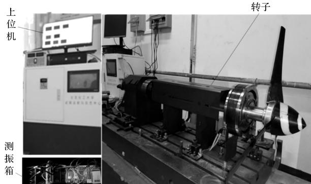
图5 转子试验台
