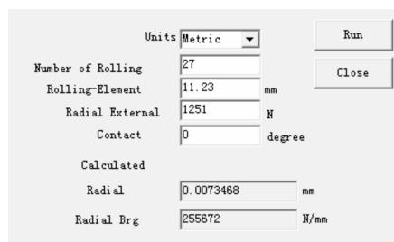
(a) 节点 11 处支撑刚度
