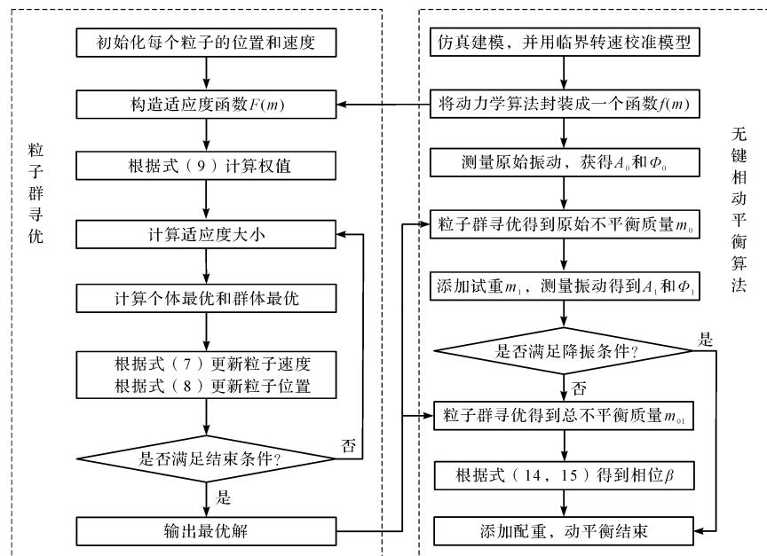
图4 基于粒子群优化的无键相动平衡算法流程图
