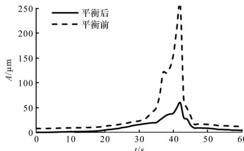
图9 平衡前后升速过临界时振动幅值变化图
