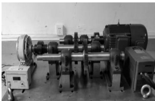
图 4 滚动轴承故障模拟试验台
