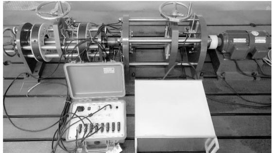
图6 ZNXGZ-50B型滚动轴承综合试验台
